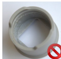
EMBOUT ENDOMMAGÉ Aspect interne et/ou externe brillant et collant
