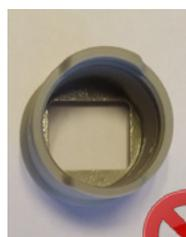
**DAMAGED CALIBRATION TIP**
