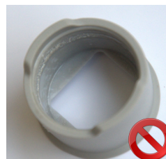
EMBOUT ENDOMMAGE Aspect interne et/ou externe brillant et collant
