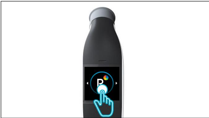
L'écran de l'appareil s'allume et l'icône prise de teinte apparaît (voir "5.3. Arborescence des interfaces du Rayplicker Cobra", page 14). La puissance du signal Wifi est indiquée en haut à droite de cet écran.
